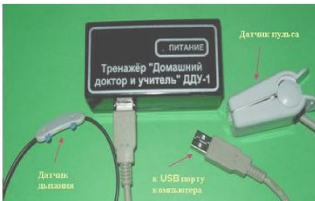
Рис. 47. Компьютерное устройство “Домашний доктор и учитель”.
